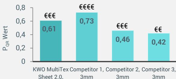
Abb. 1: Kriech-Relaxationsversuch nach EN 13555 (Steifigkeit 500 kn/mm, Anfangsflächenpressung 30 MPa, 150 °C, DN40/PN40)
