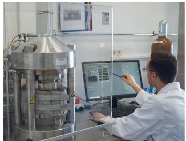
Amtec Dichtungsprüfstand TEMES fl.ai1
