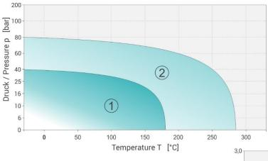
Das p-T Diagramm gibt den möglichen Einsatzbereich in Bezug auf Druck- und Temperaturverhältnisse an.
