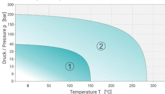
Das p-T Diagramm gibt den möglichen Einsatzbereich in Bezug auf Druck- und Temperaturverhältnisse an.
