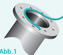
2.1. b Anbringen des Dichtungsbandes
