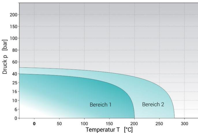
Das p-T Diagramm gibt den möglichen Einsatzbereich in Bezug auf Druck- und Temperaturverhältnisse an.
