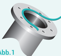
2.1. b Anbringen des Dichtungsbandes
